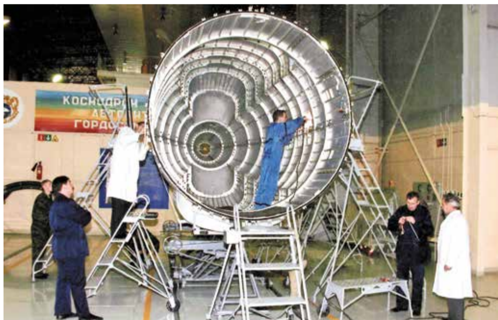
В МИКе космодрома Плесецк. Идет приемка головного обтекателя РН «Космос-3М» для запуска КА «Сар-Луле». Слева на первом плане — М.В. Шкода
