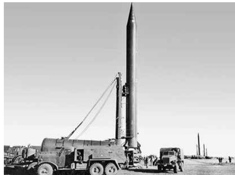
Полигон Капустин Яр. Сюда 5 мая 1957 г. была отправлена первая летная Р-12. Пуск, проведенный 22 июня 1957 г., оказался успешным. Ракета пролетела две тысячи километров и попала в цель – гору Мунду (Казахстан).
