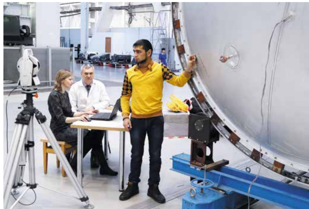
Измерение геометрических параметров топливного бака с помощью лазерного трекера ведут начальник бюро отдела 329 Н.Н. Башарин (в центре) и инженеры-программисты Е.Э. Ушакова и Р.Т. Алимов
